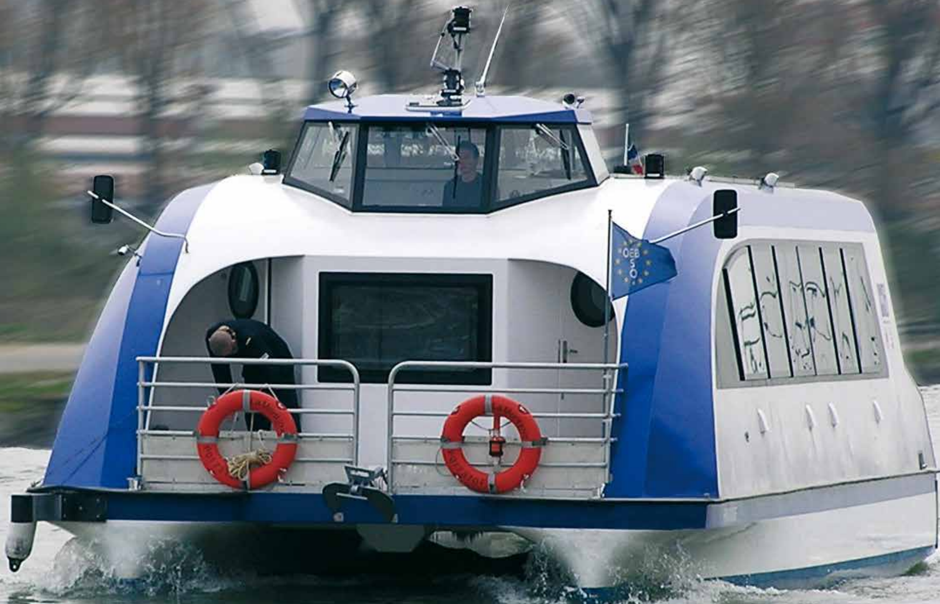
Passagierfähre in Paris mit 2 x 20 kW Unterwasser-Motoren
