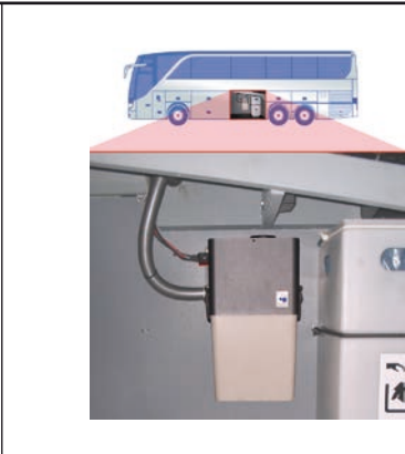
Montagebeispiel Zentralstaubsauger
